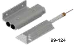
Pieza # 99-124: Interruptor magnético de límite de puerta industrial metálica montado en el piso, NEMA1 con controles de 24 Vca, requiere un panel de control o controlador de estado sólido opcional. (Instalado en sitio)
